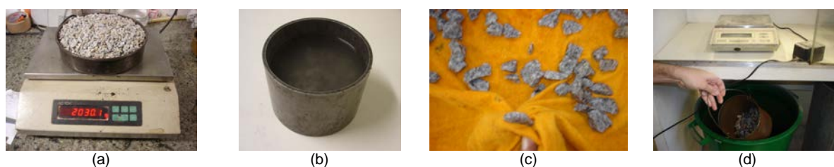
Figura 3. Etapas do ensaio de densidade e absorção do agregado graúdo
