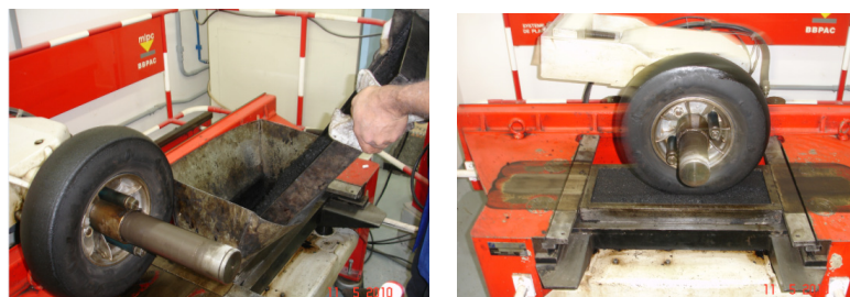
Figura 1. Compactação das placas em laboratório
