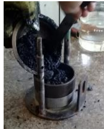
Figura 6: Aplicação da mistura asfáltica
